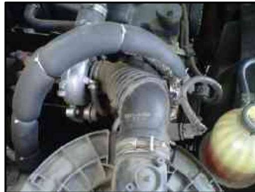
Insulator AC Innova dibungkus selang hitam
